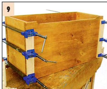
9 ...а чтобы не повредить поверхности деревянных деталей, под губки подкладывают планки.
