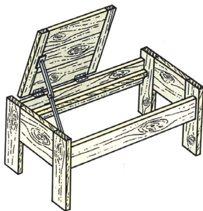
Рис. 2. В открытом положении откидную крышку удерживает подъёмный механизм.
