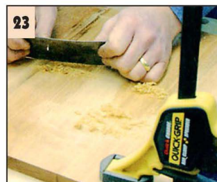
Струбцины пистолетного типа прекрасно подходят для быстрого крепления деталей к верстаку...
