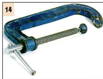
14 Часто дешёвые струбцины приходится применять с дополнительными подкладками при фиксации тонких деталей...
