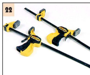
Более того, такими струбцинами можно и стягивать детали, и отжимать друг от друга.
