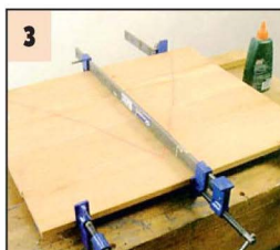
3 Для изготовления мебельных щитов понадобятся «оконные» струбцины...
