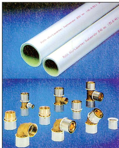
Комбинированные трубы PE-X (фирмы Roth) с алюминиевым средним слоем Laserplex. Соединять опрессовкой можно трубы диаметром 40 и 50 мм для стояков посредством фитингов из оловянно-цинковой бронзы PPSU.
